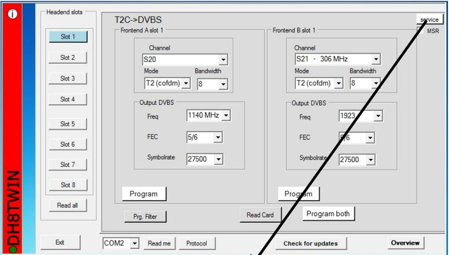
In dem Menüpunkt "service" kann der Offset der Ausgangsfrequenzkorrigiert werden.
